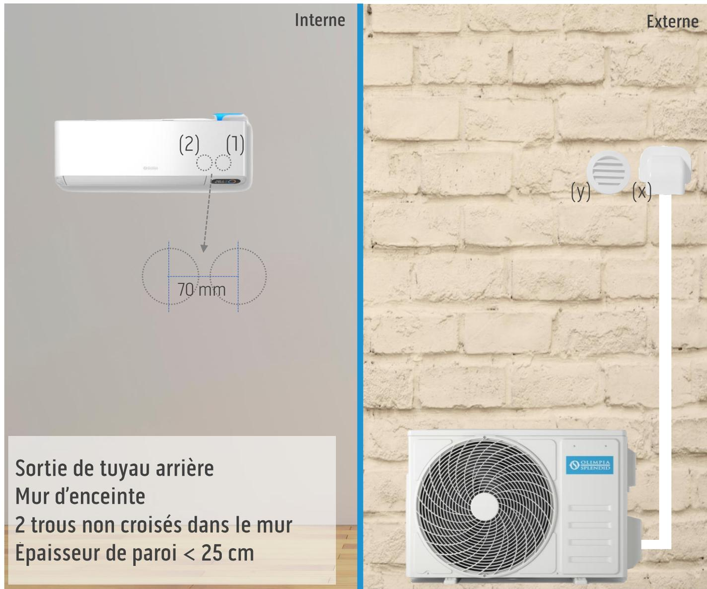
Le premier trou (1), d'un diamètre de 70 mm, sert à faire passer le tuyau d'air frais rigide (situé derrière l'unité intérieure) dans le mur.
