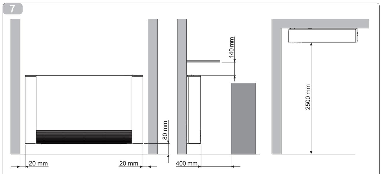
El aparato debe ser instalado en una posición que permita realizar fácilmente las operaciones de mantenimiento ordinario (limpieza del filtro) y extraordinario, así como el acceso a las válvulas de purga de aire (batería y placas), que pueden ser alcanzadas a través de la rejilla superior (en el lado de las conexiones).
