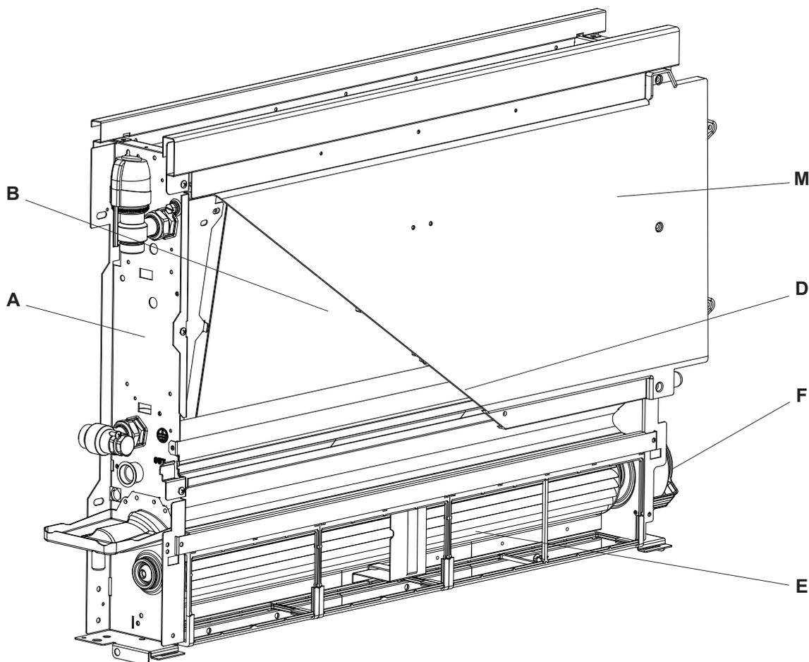
**D - Pannello radiante** ad elevata efficienza collegata alla batteria ad acqua calda (versione SLR).
